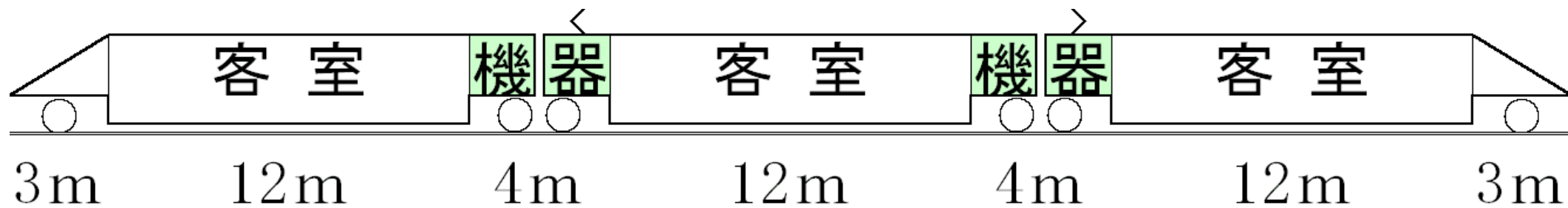
図 2 機器を床上とした 3 車体 4 連接車両
