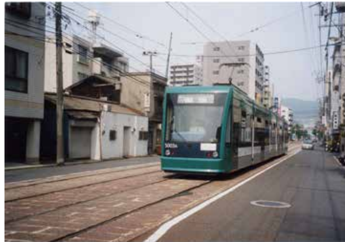
広島電鉄5000形 5連節 30m超(特認)の日本最長の路面電車
