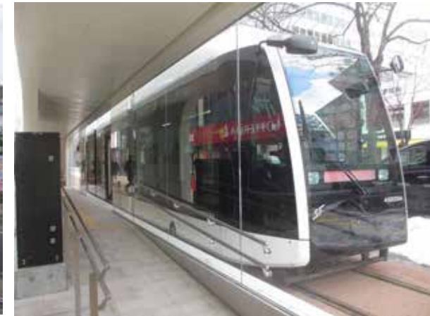
リトルダンサーUa 3連節 札幌市交通局1200形
