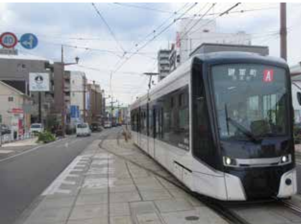
リトルダンサーnew-L 3連節 熊本市交通局2400形
