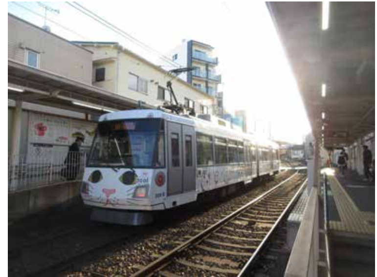
東急電鉄世田谷線 300系 高床 連節車
